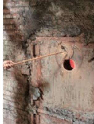
1. 金良興採用隧道窯，利用臺車連續循環燒製。
